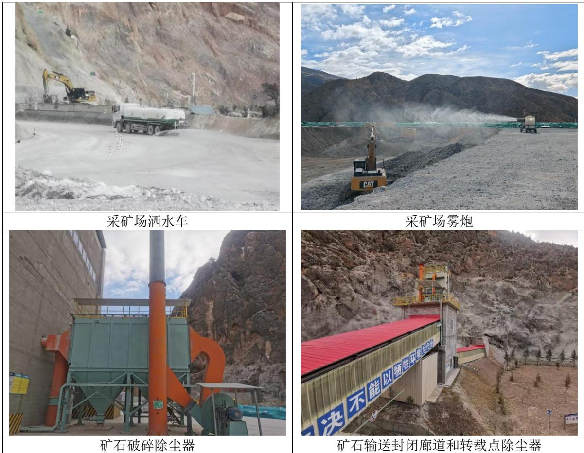
图 2.3-12 现有石灰石矿山废气污染防治措施现状照片
